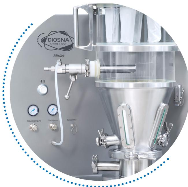
**Minilab RC con secador de lecho fluido
